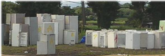
置は高さ2m以下程度に積み上げ風通しを良くする 平成27年関東・東北豪雨の栃木市の仮置場
